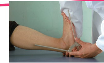
カチカチゴニオメーターは5度ごとの溝加工と本体軸側面に傾斜をつけることによって、片手で簡単かつ正確に計測ができる、新しいタイプのゴニオメーター
