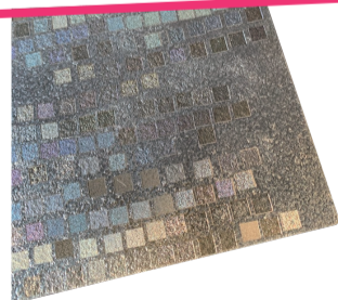
すでに確立されつつあるステン レスやチタンへの発色技術に 対し、困難とされていた融点の 低い錫へのレーザー発色に 成功
