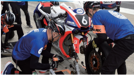
鈴鹿8時間耐久レースでは0.1秒を争うタイヤ交換を素早くスムーズに行うため、アクスルシャフトの精度と耐久性・耐摩耗性・平滑性などが大きく貢献する
