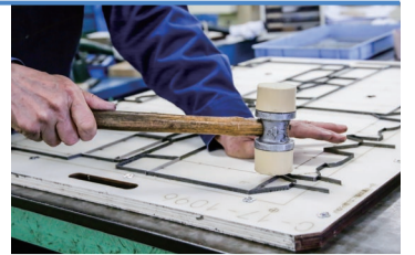
ベニヤ板にレーザーで溝加工を施し、溝の形状に合わせて曲げられた刃物を埋め込んでいく、専門性が高いトムソン型製造
