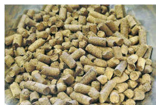
木材を炭素化、乾燥・圧縮して木質バイオマスのペレットにする。生木から炭になるまで約10分、全工程でも25分ほど。炭素化することでカロリーも30%アップ
