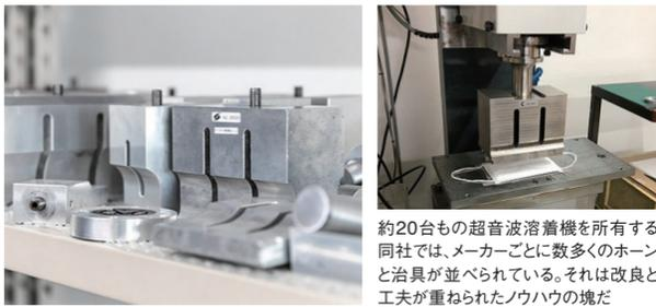
約20台もの超音波溶着機を所有する同社では、メーカーごとに数多くのホーンと治具が並べられている。それは改良と工夫を重ねられたノウハウの塊だ
