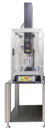
サーボ駆動なのにエネルギーを5段階変化が可能で、細かく制御のできる「タラタ特注」超音波機械。ポンプなどの水回りの品の製造に使われている
