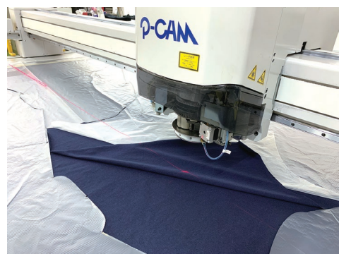
CAMの導入により、外注していた裁断も内製化。何枚も重ねた生地をコンピュータ制御によりカットしていく。カメラを使用することでプリントされたパターンを自動で認識して裁断する
