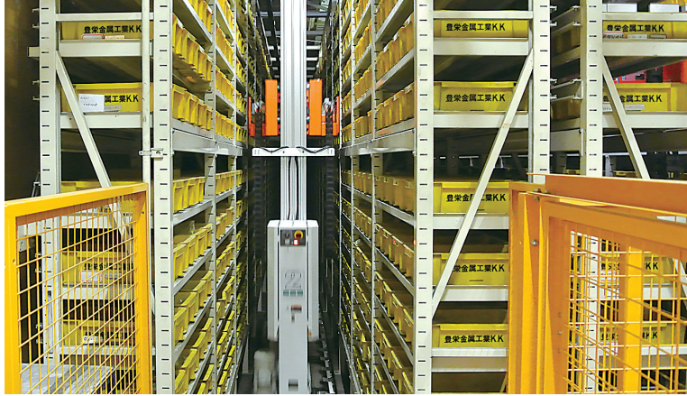
金型・製品の自動収納倉庫がつくられたのは約40年前。現用金型が6000面保管されている。
