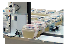
紙・フィルムテープ兼用のWAS-250型・400型。150mmの幅広テープが使えるモデル。印刷テープの位置決めが可能な自動帯束機を製造するのは、全国でもここだけ
