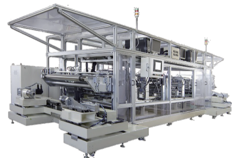
リチウムイオン電池絶縁テープ貼り付け装置。リチウム電池の発火防止用に開発した装置、画像で位置を確認しながら高速で絶縁テープを貼りつける
