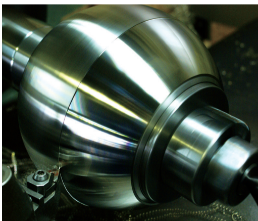
市場が求める水準以上の真球度と表面粗さを実現。「限りなくまん丸」「限りなく滑らか」がコア技術。8mm～1,200mmまでの大きさに対応
