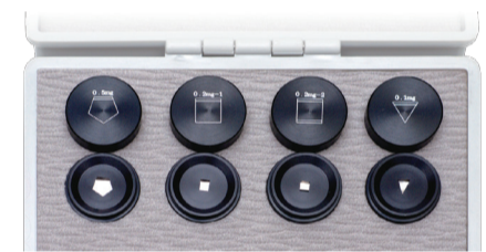
「サブミリグラム分銅」は0.5mg、0.2mg×2、0.1mgのセット。チタンを箔のように薄くカットするのは手仕事で、この重さにビタリと合わせるのまさに職人技。また加工時には熱で膨張した素材が、冷えたときの質量を見越して計測するが、これも職人の勘どころだ
