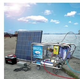
熊本地震の際にも使われた、全水域に対応した災害用飲料水製造装置。地下水、河川水、海水など、あらゆる水から安全な飲料水をつくりだす。トランク型の軽量タイプもある
