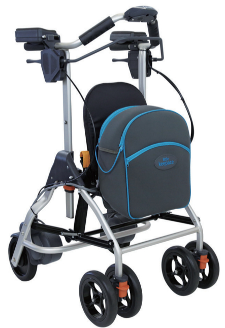
業界初のロボット技術搭載歩行器「リトルキーバス」。センサー感知による坂道でのスピード調整や転倒防止ブレーキ機能を搭載。ハンドルに静電気センサーを搭載し、手が離れた瞬間に止まり、さらに5分間触らなければ電源が切れるため消し忘れもない。バッテリーはフル充電で4時間使用可能
