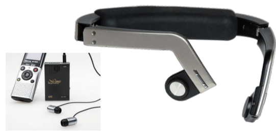
最新骨伝導技術と空気伝導を組み合わせ、試聴音域を広げることができるハイブリッド型イヤホン「OSONIC」。従来の補聴器だとマイクで拾った音をアンプを使って音量を上げていくため、音が割れたり音漏れもひどいが、これは適度な音量で聞くことができる。現場で使う無線通信装置にBluetoothのユニットを使えば、両手作業も可能に
