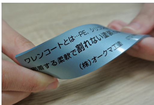
ワレンコートという名の通り、塗装した軟質素材は曲げても割れない。通常の塗装であれば曲げるとヒビが入るが、ワレンコートで塗装すると180度曲げても割れることはない
