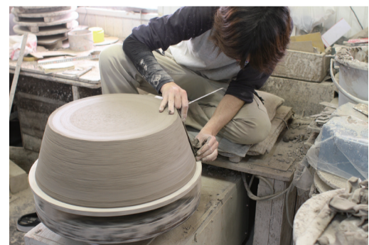
今や大型の坩堝製造ができるのは、国内でも奥村坩堝製造所と他に1社だけ。坩堝はガラスを熔融するための窯の中で1,350度もの高熱で繰り返し使われるため、寿命は長くても2〜3カ月ほど。その苛酷な環境でいかに安定して長持ちする坩堝を作れるかが、腕の見せどころ
