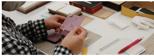
紙は1枚1枚レーザー加工したものを、手作業で積み重ねて制作している。検品で紙が切り取れてない細かな部分は、ピンセットを使って切り離していく
