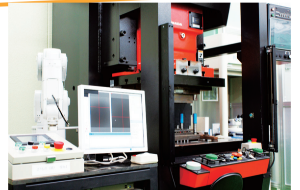
±5μm超高精度位置決めプレス装置。製品の回路パターンを画像認識、ロボットハンドで基板を動かし指定の場所へ±5μmの精度で位置決め後にプレス加工をおこなう
