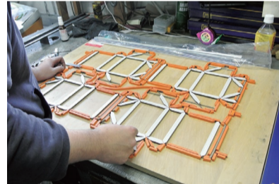
紙器のもととなる厚紙を、展開図の形にくり抜くトムソン加工。ベースの木板に溝を掘り、溝の部分に刃を入れた型を利用することで、型を作成していく
