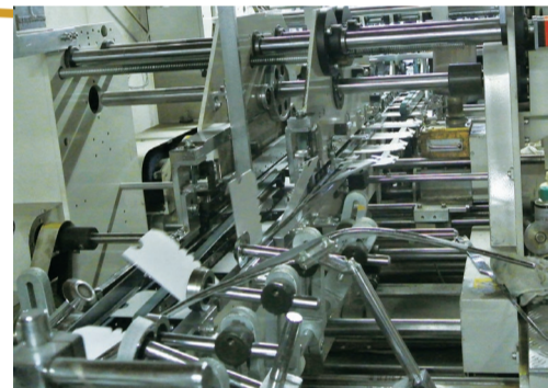
トムソン加工した製品をのり付け、貼り合わせるサクマシオン。転写式の糊付けは、高速に流れる箱1つひとつにピンポイントで当てるため、タイミング調整が必要
