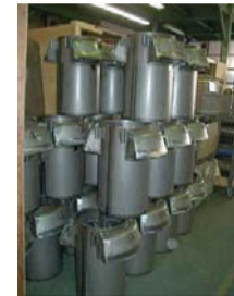
変圧器ケース
