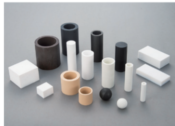
強度を高めるためにカーボンやガラスが配合された充填剤成形品。本来 PTFE は電気を通さないが、これによって通電できるグレードの PTFE も成形できる
