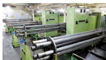
量産力を発揮する6軸自動旋盤
