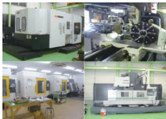
3000mmまでの長尺部品の精密加工に対応する機械設備
